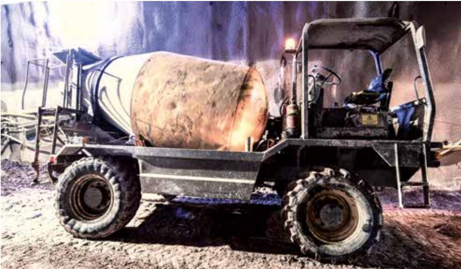
Minibetonmischer für den Antransport von Spritzbeton im Tunnel [2016]
