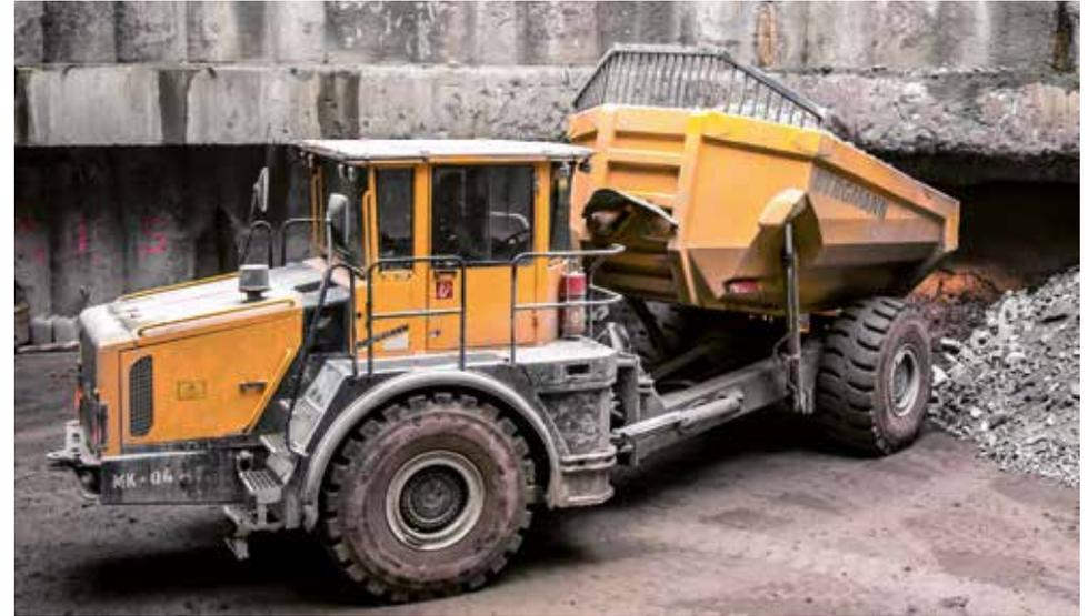
Knickgelenkter Tunnel-Dumper legt Abraum für den Weitertransport bereit [2016]
