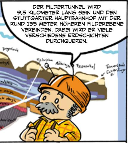
DER FILDERTUNNEL WIRD 9,5 KILOMETER LANG SEIN UND DEN STUTTGARTER HAUPTBAHNHOF MIT DER RUND 155 METER HÖHEREN FILDEREBENE VERBINDEN. DABEI WIRD ER VIELE VERSCHIEDENE ERDSCHICHTEN DURCHQUEREN.
